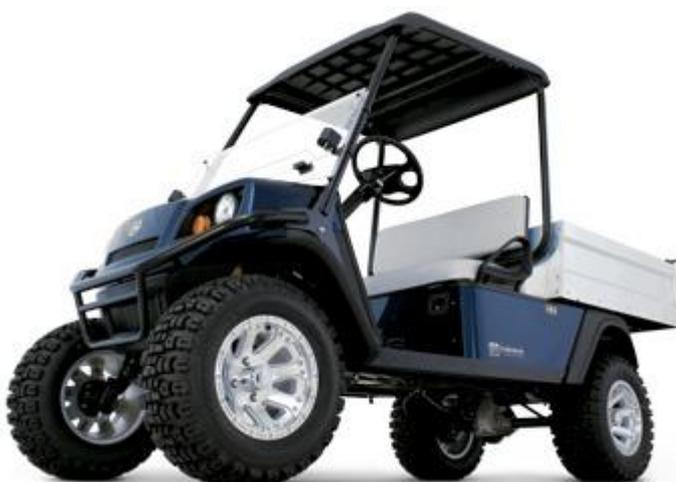
Le Hauler 1200X Electrique est un véhicule polyvalent robuste qui peut réaliser un grand nombre de tâches. Avec sa transmission électrique de 48 V et sa bonne garde au sol, il peut transporter des charges jusqu'à 250 kg dans une zone de travail tout en maintenant les émissions à un faible niveau. Il peut également être personnalisé avec un grand nombre d'options et d'accessoires.
